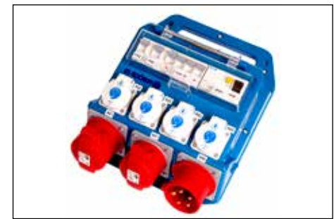
Verdeelkast Björn Mini In: 400V-5p/32A. Uit: 4p/32A, 5p/16A en 4 x 230V/16A
