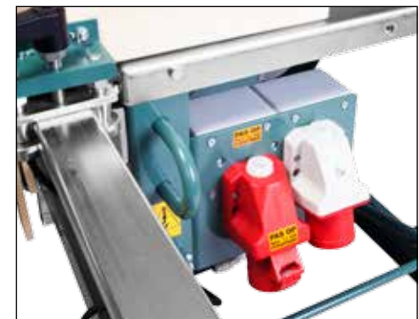
1603 Schakelkast Speciale combinatie voor machine en stofafzuiger. Te bedienen met één schakelaar.
