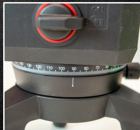
Betere positionering door stelvoet met 360° fijninstelling
