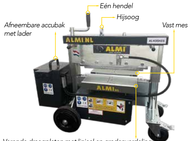
Verende draagplaten met liniaal en gradenverdeling Gelijkmatige drukverdeling met 5 cilinders
