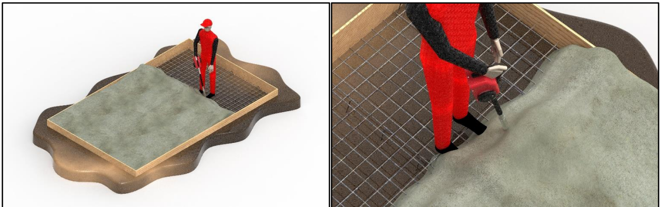
Figuur 6: Werkwijze tijdens het beton verdichten.
