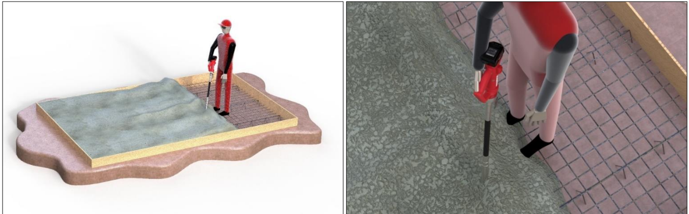
Figuur 6: Werkwijze tijdens het beton verdichten.
